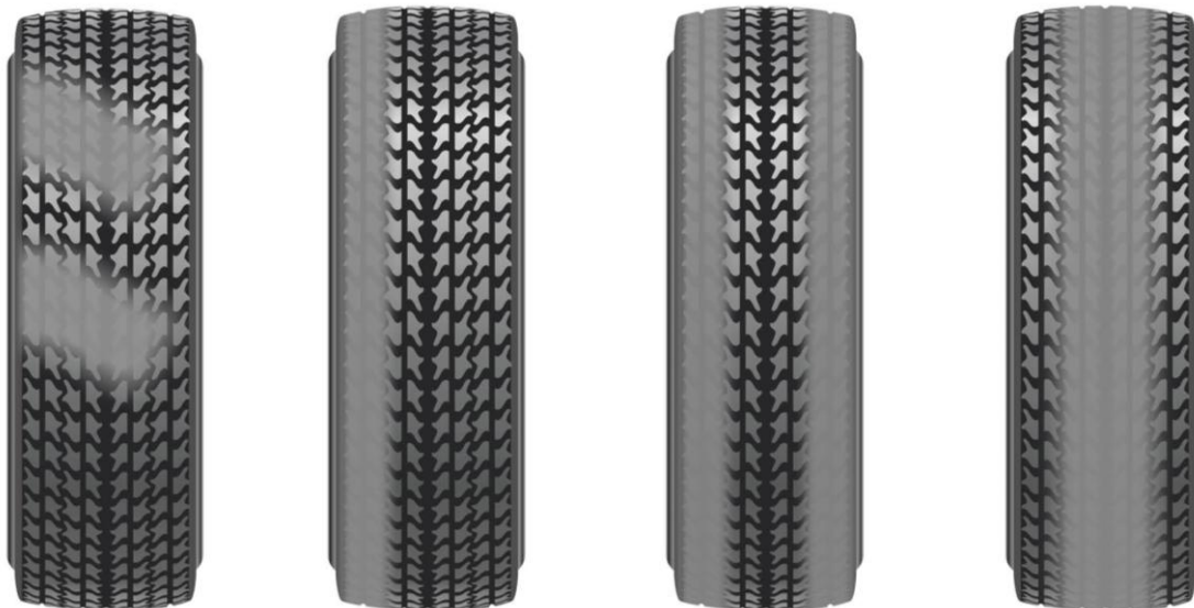
Lengéscsillapító hiba (kagylós kopás)
